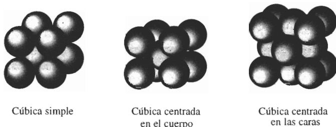
FIGURA 3-6 Los modelos de celdas unitarias cúbica simple (CS), cúbica centrada en el cuerpo (CC) y cúbica centrada en las caras (CCC), suponiendo un solo átomo por punto de red.
